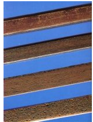
Ces photographies sont prises sous un microscope montrant les différentes caractéristiques d'usure sur un fil aérien lors de l'utilisation de carbone, cuivre, métal fritté et aluminium comme matériel pour frotteur de prise de courant.
